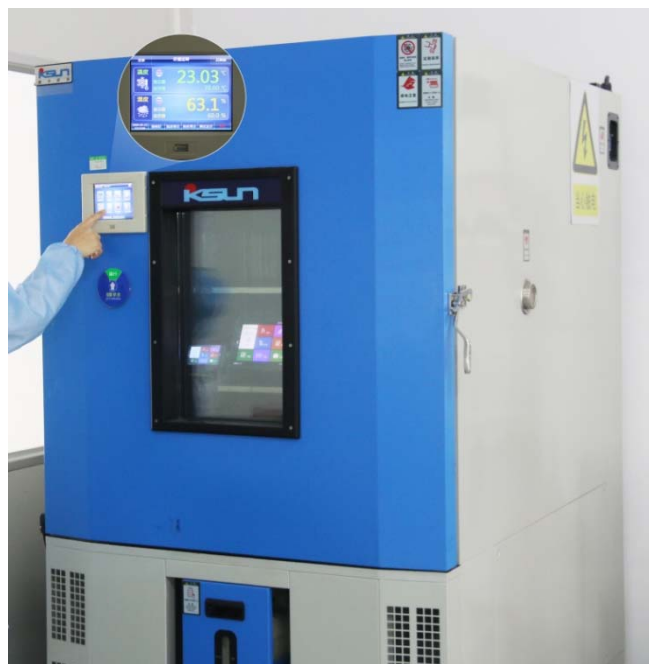
图 3-3 高低温老化测试图
