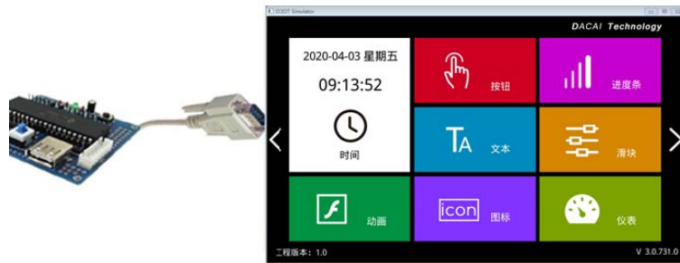
图 10-2 用户单片机串口与“虚拟串口屏”联机调试
