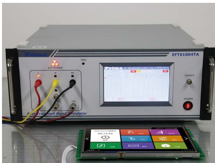
图 3-4 群脉冲测试图
